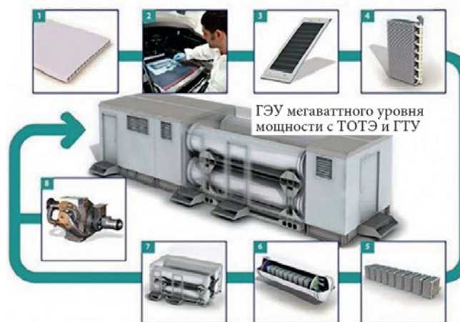
Рис. 3. Этапы изготовления ЭУ на примере прототипа гибридной ЭУ с ТОТЭ и микро-ГТУ мощностью 1250 кВт фирмы Mitsubishi Heavy Industries (MHI)
